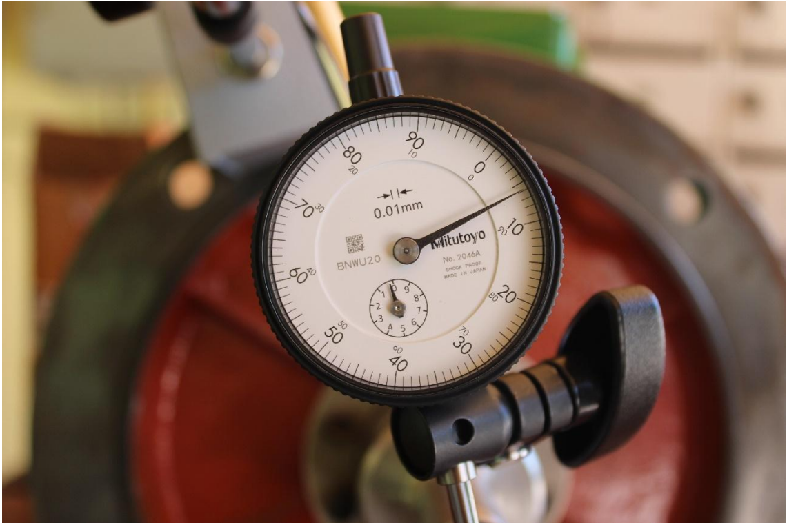
Figura 13: Control Run-Out de eje Pista Referencial [Ref. Reloj de Carátula 0.06 [mm]]
