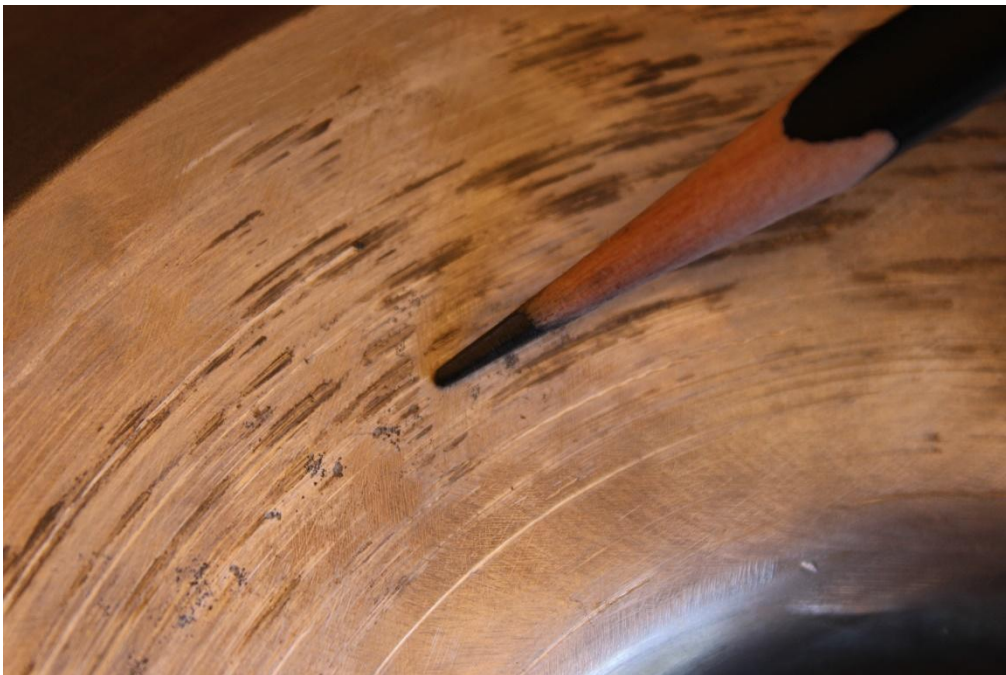
Figura 03: Desprendimiento severo en Tapa Delantera
