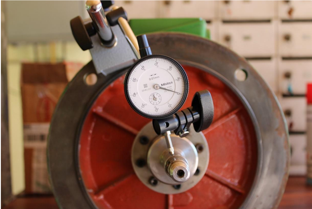
Figura 09: Control Run-Out de eje Pista de Sello Mecánico [Ref. Reloj de Carátula 0.00 [mm]]
