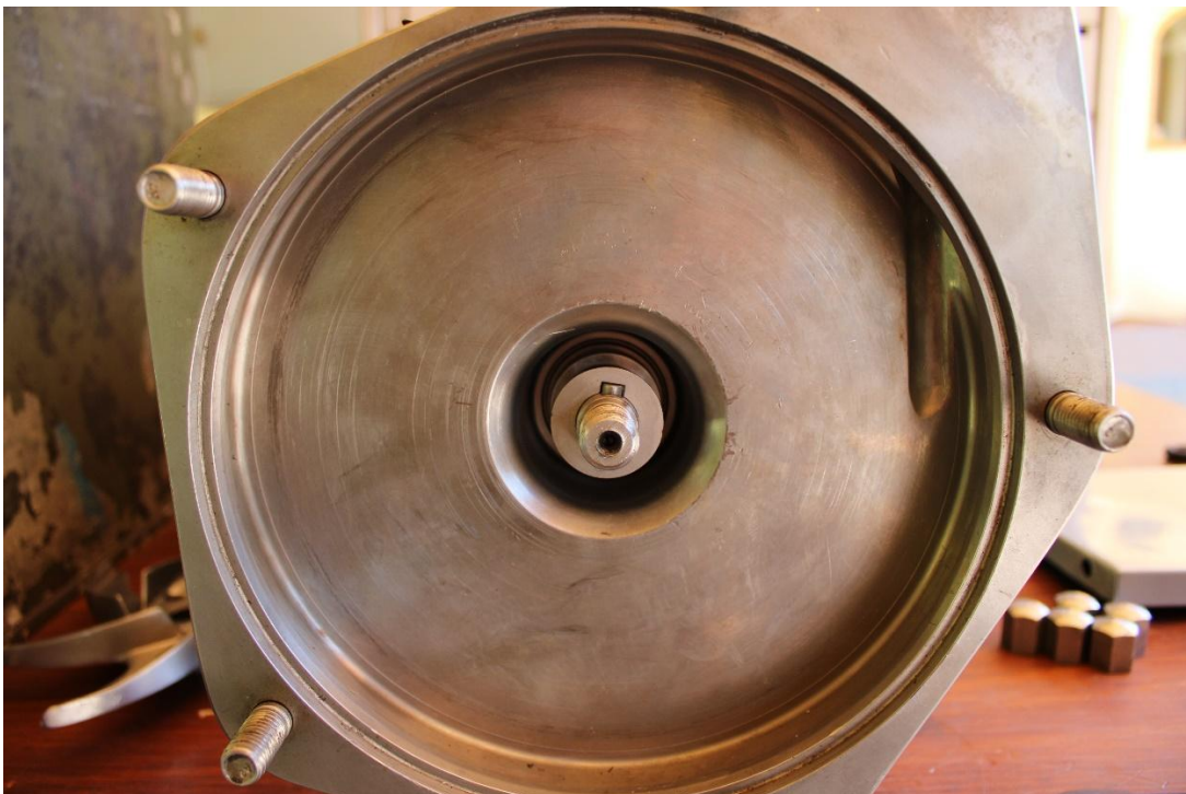
Figura 06: Tapa Trasera sólo requiere puesta a punto y eliminación de punto altos.
