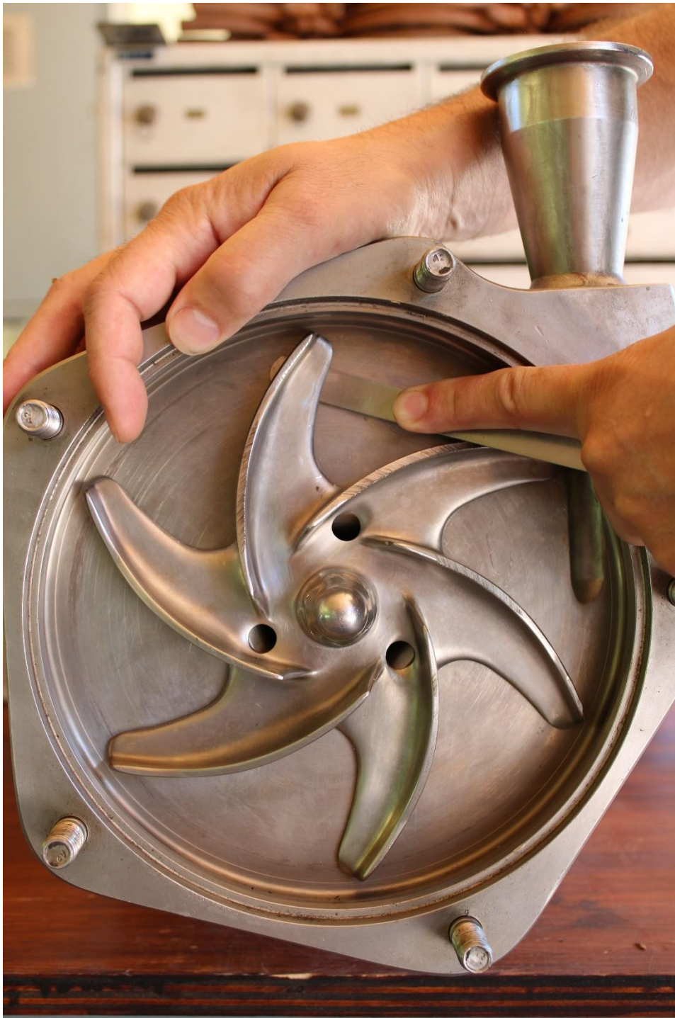
Figura 04: La holgura Impulsor / Tapa Trasera 1.6 [mm] excede la holgura de diseño 0.5 [mm]
