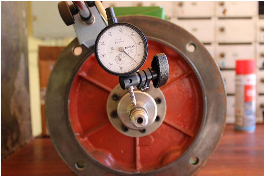
Figura 10: Control Run-Out de eje Pista Sello Mecánico [Ref. Reloj de Carátula 0.06 [mm]]
