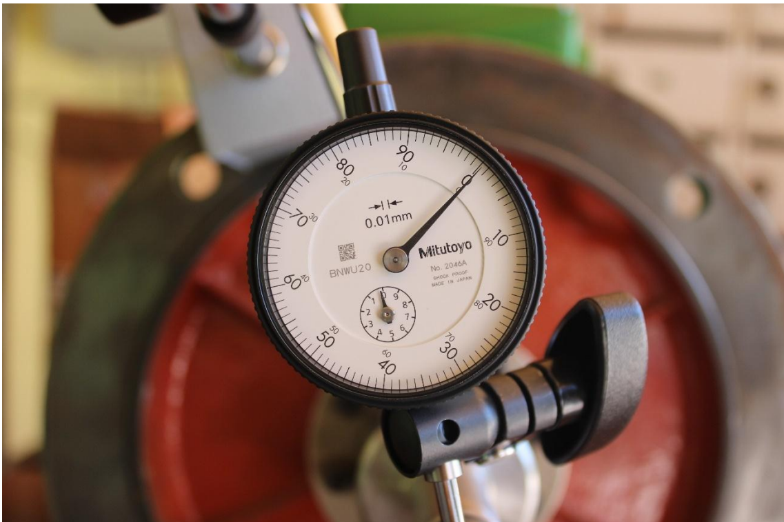
Figura 12: Control Run-Out de eje Pista Referencial [Ref. Reloj de Carátula 0.00 [mm]]
